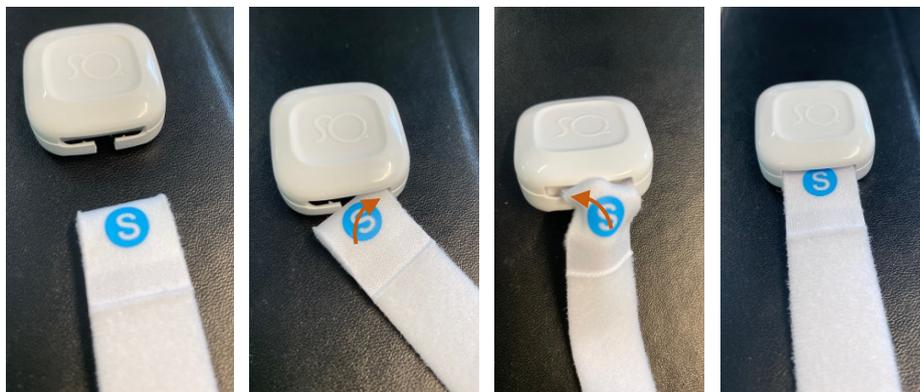
Figura 12: montaje de la Gabi Band
