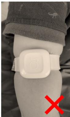
Figura 31: mal ajustado: demasiado apretado
